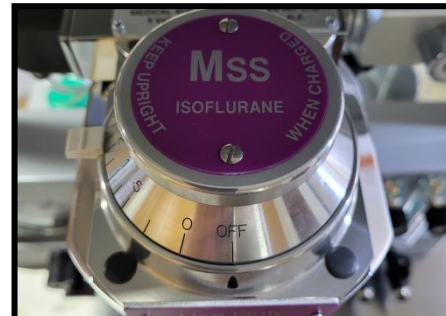
VAPORIZADOR EN "OFF" Y PROCEDER AL LLENADO DEL VAPORIZADOR
